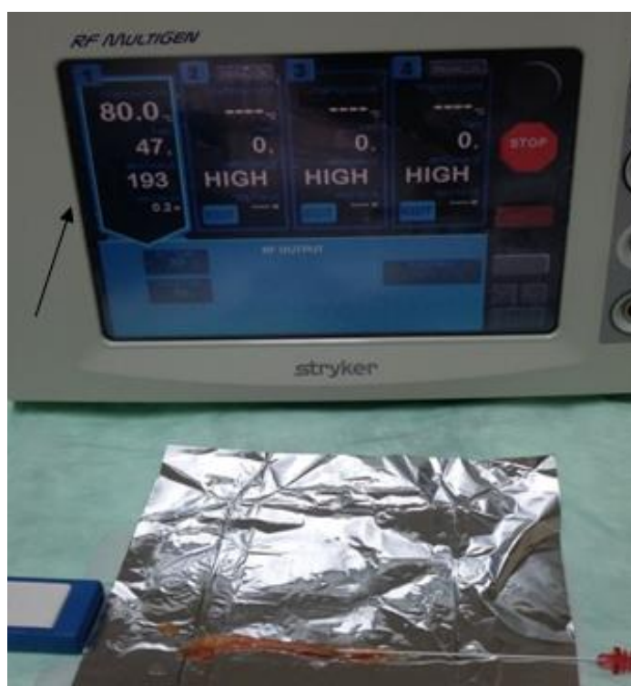
Рис. 2.2 Процесс радиочастотной деструкции в течение 90 секунд при температуре 80° С
